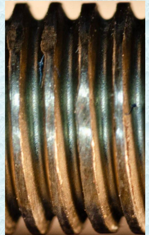
Рис 3. Вид резьбовой части болта. Стрелками показаны: 1 – следы износа на поверхностях вершин витков резьбы; 2 – смятие материала вершин витков.
