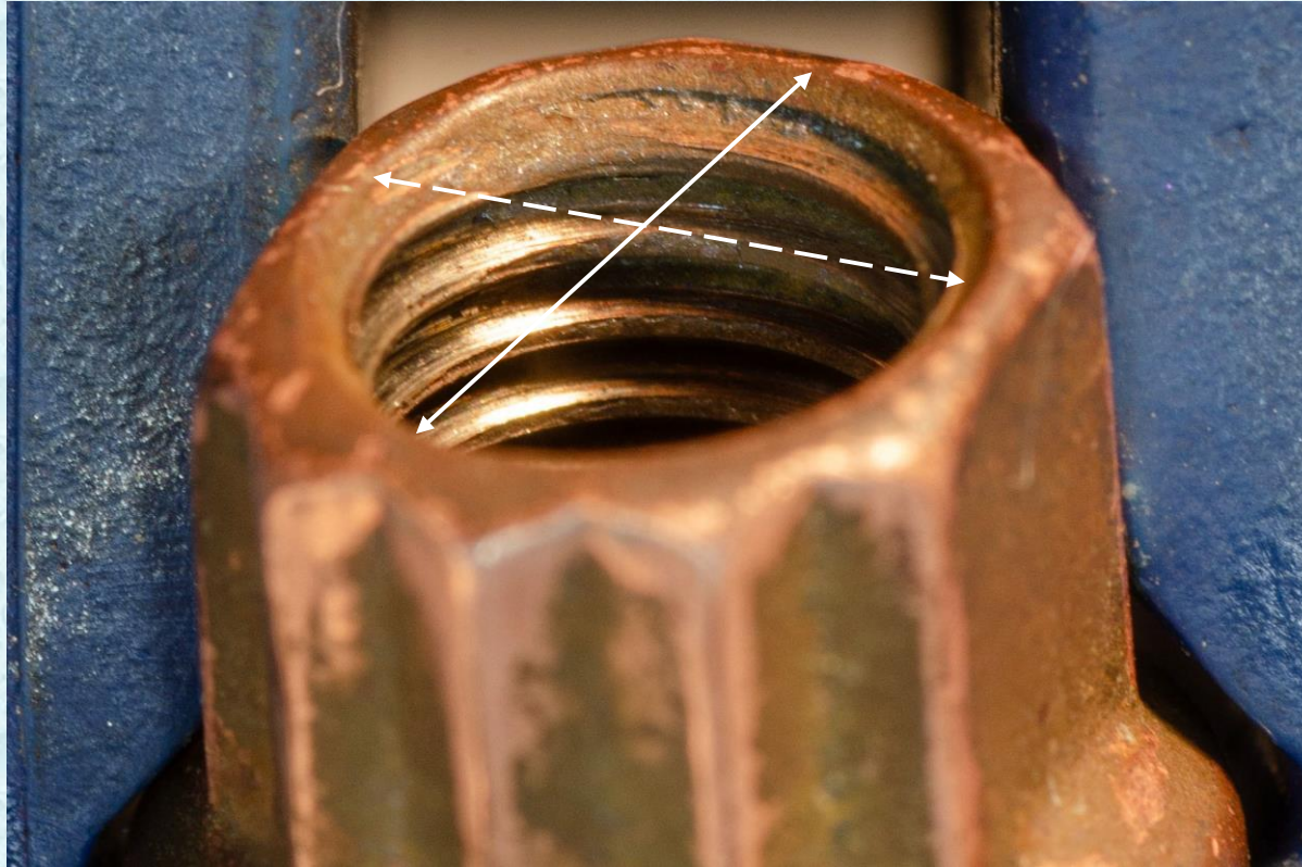
Рис. 2. Вид деформации венца гайки. Стрелками указаны малая полуось эллипса (пунктирная линия) и большая полуось эллипса (сплошная линия).
