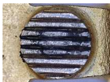
Рис. 4. Виды контактов микропереключателя В1. НЗ пара (а), НО пара (б).
