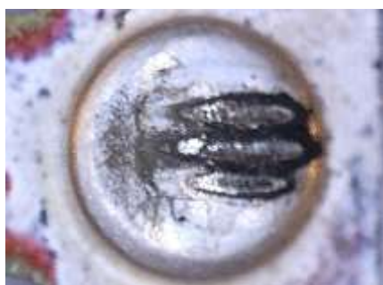
Рис. 4. Виды контактов микропереключателя В1. НЗ пара (а), НО пара (б).
