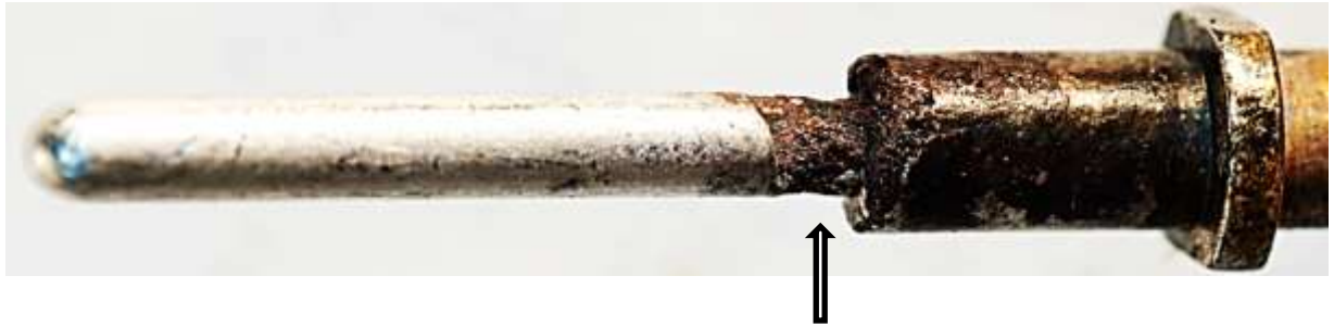
Рис. 7. Вид повреждений (показаны стрелками) электроэрозией выводов № 2 (а) и № 1 (б).
