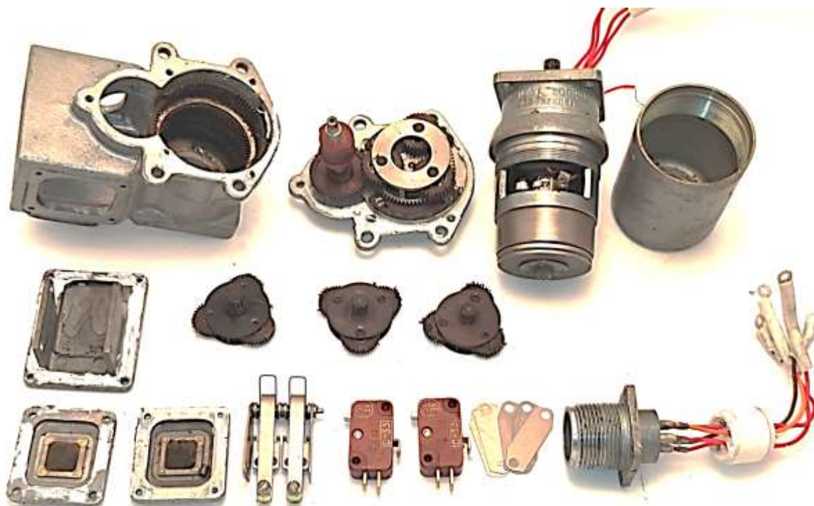
Рис. 2. Вид деталей электромеханизма ЭПВ-150МТ сер. 2 № 009322999А после разборки.
