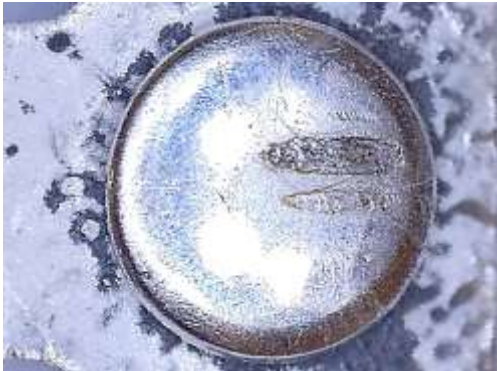
Рис. 5. Виды контактов микропереключателя В2. НЗ пара (а), НО пара (б).
