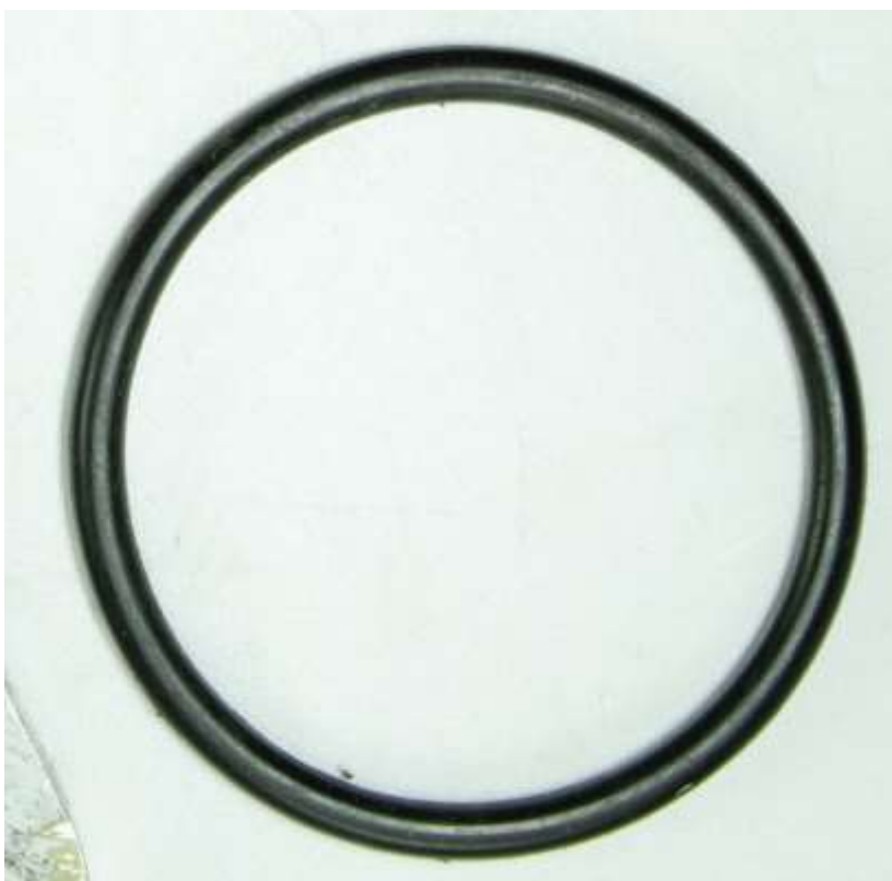
Рис. 7. Виды (а, б) резинового уплотнительного кольца шкворня с двух сторон.
