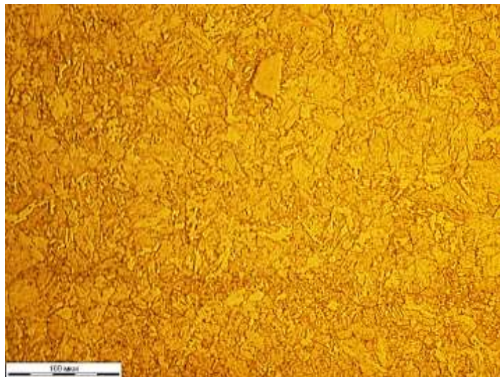
Рис. 18. Вид микроструктуры материала шпильки на удалении от зоны разрушения.
