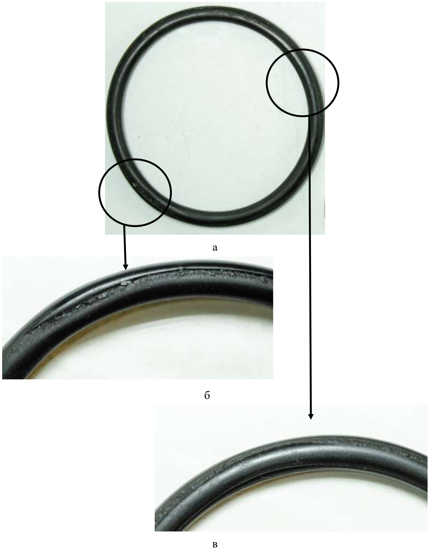
Рис. 5. Виды износа (а, б, в) резинового уплотнения стопорной пластины со стороны контакта с пластиной.
